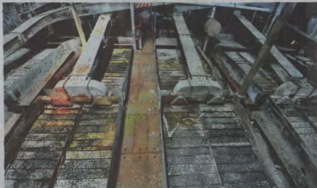
PENGAYAK yang berperanan mengasingkan bijih timah dengan bendasing seperti batu-batu kecil dan pasir.
