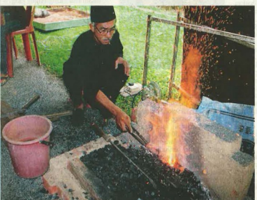
DAPUR arang digunakan untuk melebur campuran besi.
