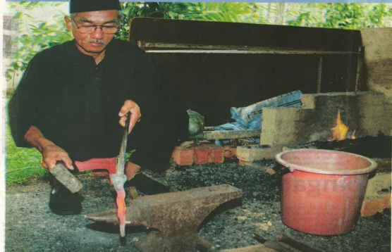
ABDUL Mazin Abdul Jami mementa mata keris yang telah terbentuk secara miring sehingga bentuknya membengkok ke bawah.
